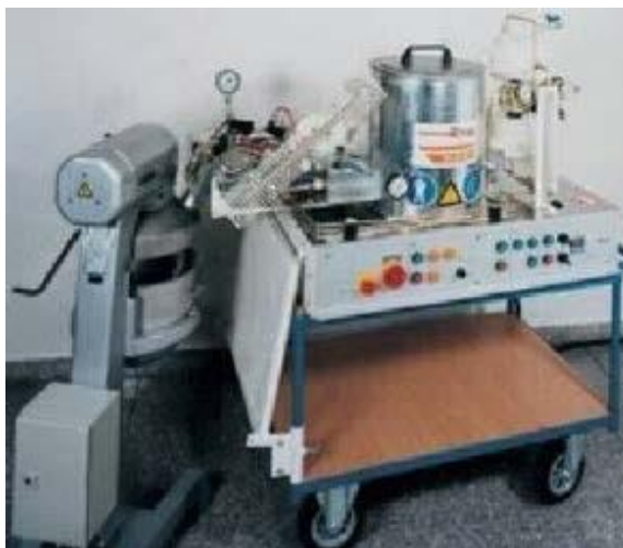
Figura 785 - 1. Planta de laboratorio para producir asfalto espumado
